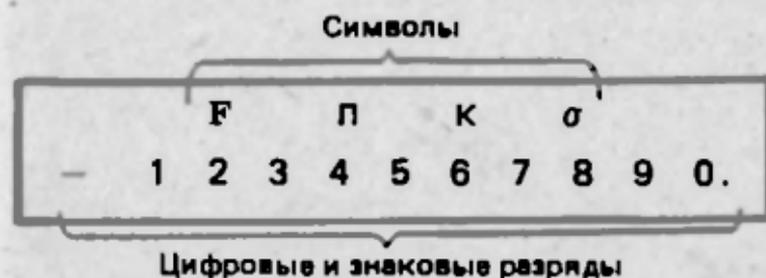
Ф — индикация режима совмещенной функции.
