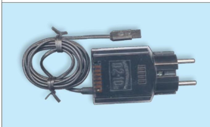
**Рис.4. Внешний блок питания "Электроника Д2-10К"**
